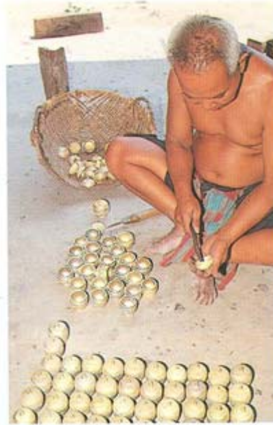
ช่างหล่อกำลังตกแต่งงานหล่อทองเหลือง
