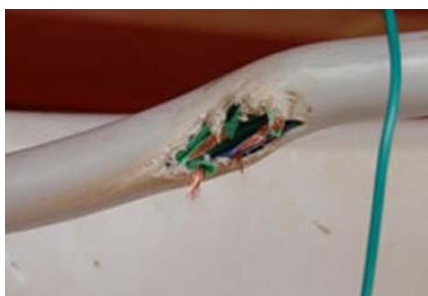
ตำแหน่งที่สายมีรอยหัก สายไฟภายในอาจหักชำรุด
