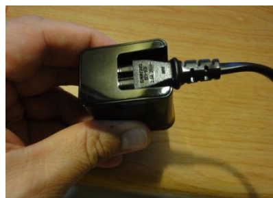
ที่ขั้วปลั๊กเสียบอาจคลายตัวทำให้ปลายสายที่ พันหลุดทำให้ดูไม่แน่น ไฟจึงเดินไม่สะดวก
